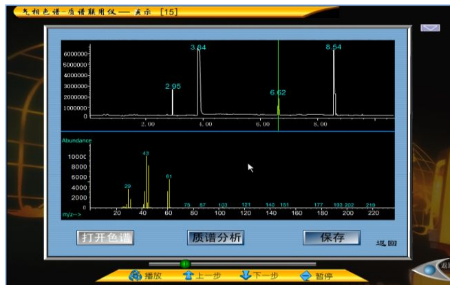
GC-MS 联用仪对中药成分的分离分析
